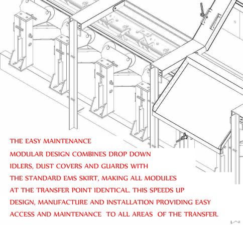
FULLY ASSEMBLED SINGLE MODULE IN OPERATIONAL POSITION
