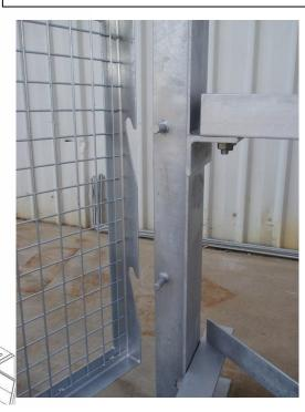
D.I.L.O GUARD IS DROPPED DOWN INTO POSITION & SITS ON RODS WHICH ARE PART OF THE DUST COVER SUPPORT POST
